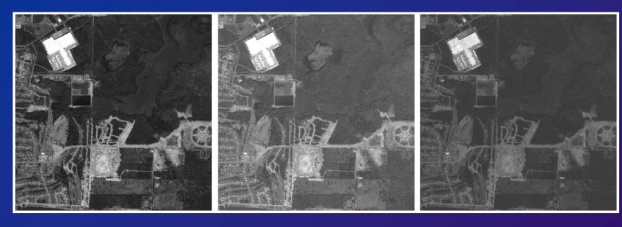
Band 3 0.63-0.69 µm Band 2 0.52-0.60 μm Band 1 0.40-0.52 μm
